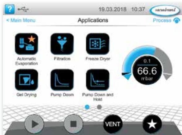
В VACUU-SELECT установлены готовые программы вакуумирования для большинства распространенных лабораторных задач. Этапы процесса и параметры вакуумного контроля можно легко отредактировать и сохранить нужные для Вашего процесса параметры, просто используйте следующую инструкцию:
