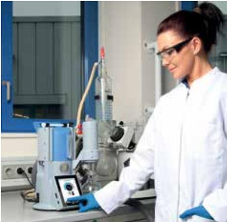
Режим автоматического испарения идеально подходит для контроля таких процессов, как ротационное выпаривание или вакуумная перегонка. Простое нажатие на кнопку «Старт» – и давление кипения в системе будет определено автоматически и в дальнейшем поддерживаться на протяжении всего процесса. Это позволяет проводить процессы быстро и без образования пены. Нет необходимости в корректировке параметров и постоянном визуальном контроле протекающего процесса.
